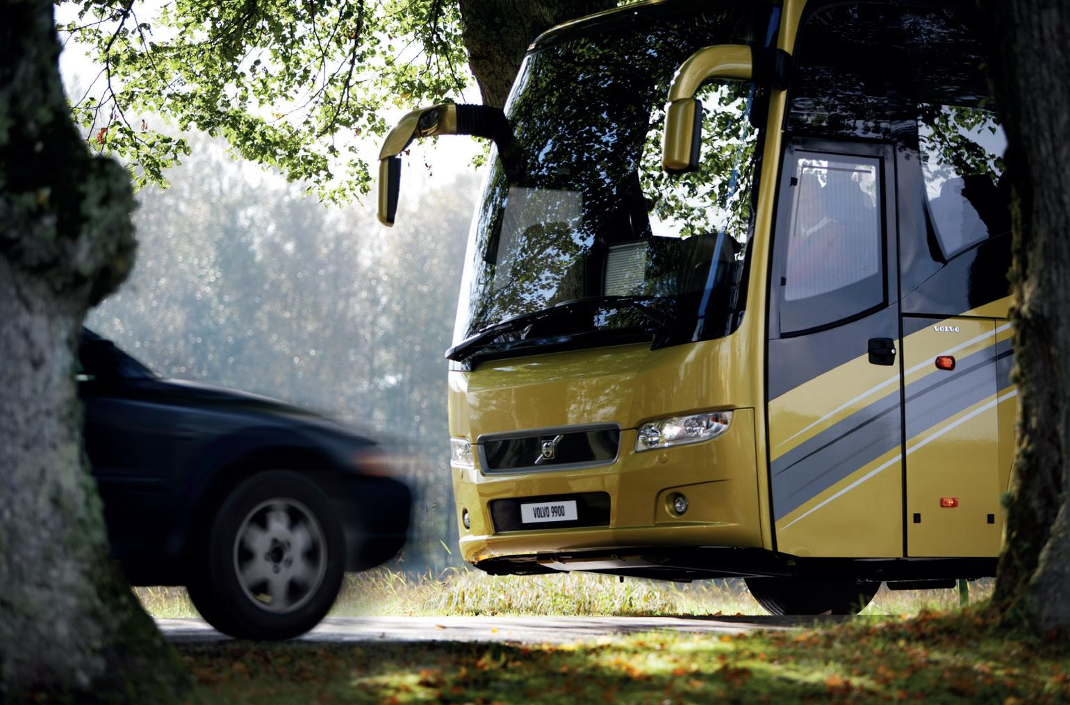
En 2015 Autobuses Volvo introdujo el Sistema de Aviso de Colisión Frontal (Forward Collision Warning, FCW) y el Sistema de Frenado de Emergencia (Emergency Braking, EBA). Esta tecnología utiliza tanto radar como cámara para detectar a los vehículos que están delante. Si la colisión es inminente, el conductor recibe un aviso visual y acústico. Si el conductor no reacciona, se activa el pre-frenado, seguido de un frenado total. Esta tecnología será obligatoria en autocares en Europa en 2018.
