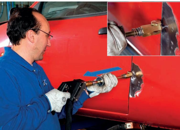
*Desabollado mediante útiles soldados.*
