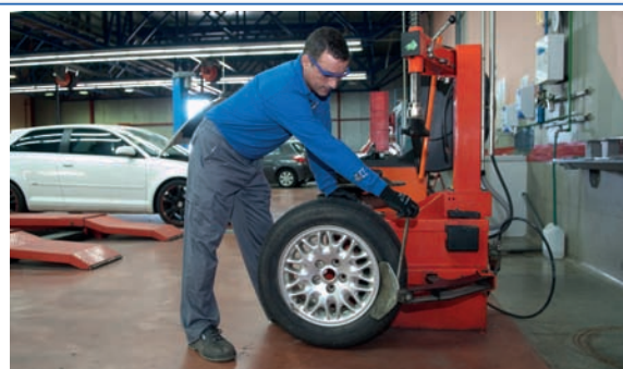
2 Con el despegatalones, se procede a despegar el talón del lado exterior e interior.
