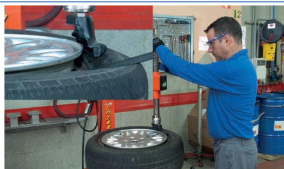
4 Posicionar y ajustar el brazo de desmontaje al borde de la llanta.
