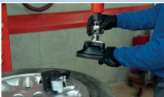
3 Colocar la rueda en la desmontadora y el adaptador VM en la garra.
