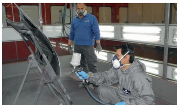
Para un alto espesor, se prepara con una relación de mezcla de 4:1 con los catalizadores P4000 (lento), P5000 (estándar) o P6000 (rápido) añadiendo entre 0 y 10 % de diluyente S322. Se recomienda una aplicación de 2-3 manos, obteniendo entre 70 y 90 micras en cada una y pudiendo lijar después de 1,5 - 2 horas de secado a 20 °C, según catalizador.
