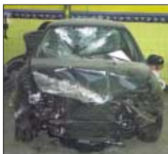
VISTA DEL FRONTAL DE UN TURISMO QUE HA SUFRIDO IMPORTANTES DEFORMACIONES EN SU CAPÓ, REJILLA FRONTAL, ALETAS Y LUNA PARABRISAS, ENTRE OTROS ELEMENTOS, PERO SUS AIRBAG FRONTALES NO LLEGARON A ACTIVARSE.
