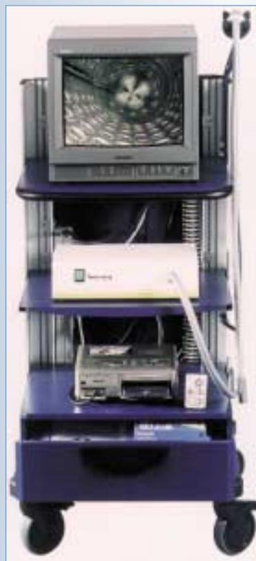
A partir de ahora, será mucho más fácil y más rápido determinar con precisión la existencia de problemas dentro de un sistema de escape, gracias a una herramienta de diagnóstico revolucionaria preparada por Walker. Usando tecnología desarrollada en la Medicina, el nuevo Endoscopio Walker permite a los mecánicos indagar por dentro de los componentes principales del escape sin tener que desmantelar éstos.
