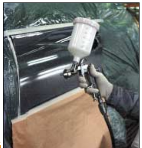
APLICACIÓN DE PINTURA CON LA IWATA W-400
