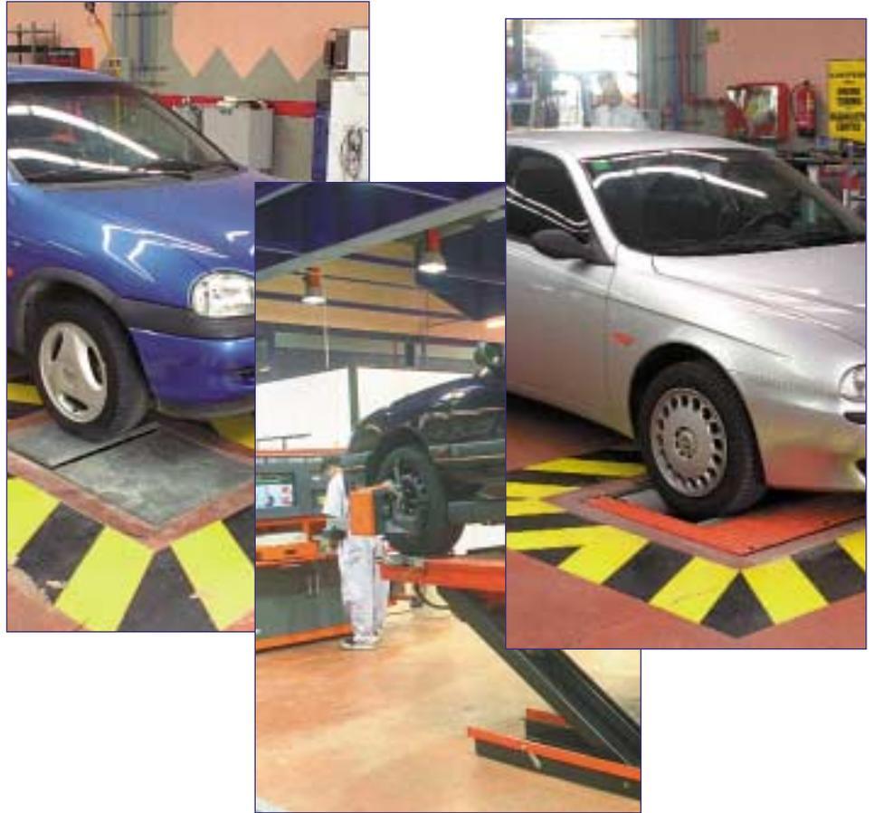
respecto a los comprobadores individuales, es la diagnosis de forma conjunta y combinada en una misma prueba de carácter dinámico de los parámetros activos en materia de alineación, suspensión y frenado.
