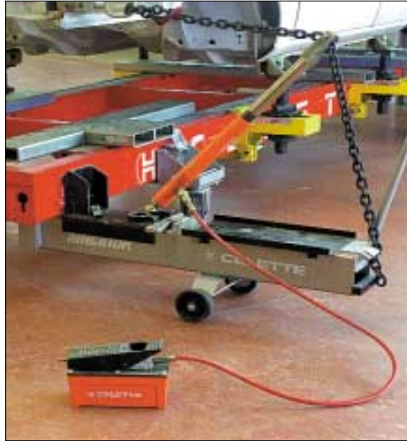
TIRO VECTORIAL MEDIANTE ARIETE FORMADO POR UN GATO HIDRAÚLICO
