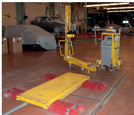
*Las minibancadas han sido diseñadas para reparar los daños producidos en golpes de baja o moderada intensidad.*
