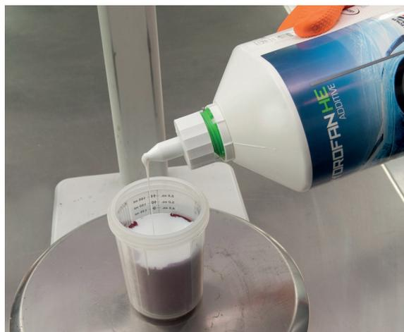
En acabados tricapas, se aconseja aplicar a la segunda base de color un 15% de HR912 Hydrofan Easyflow Reducer a la base mezclada con HR101.
