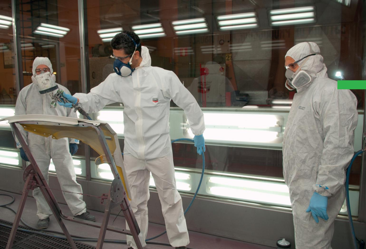
En el caso de aplicar a continuación el barniz MC380 Macrofan Airtech UHS Clearcoat, debe activarse la base con un 5% de HH980 Hydrofan Basecoat Activator. Al activarse, la base bicapa pasará a tener una vida de mezcla o pot life de 2 horas a 20°C.
