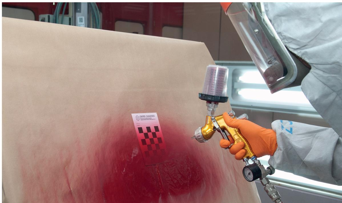
*Mejora de la cubrición de la base de color con el método High Efficiency.*
