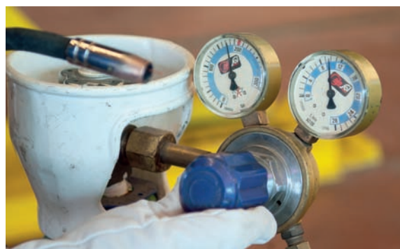
El caudal de gas de protección es un parámetro de regulación.
