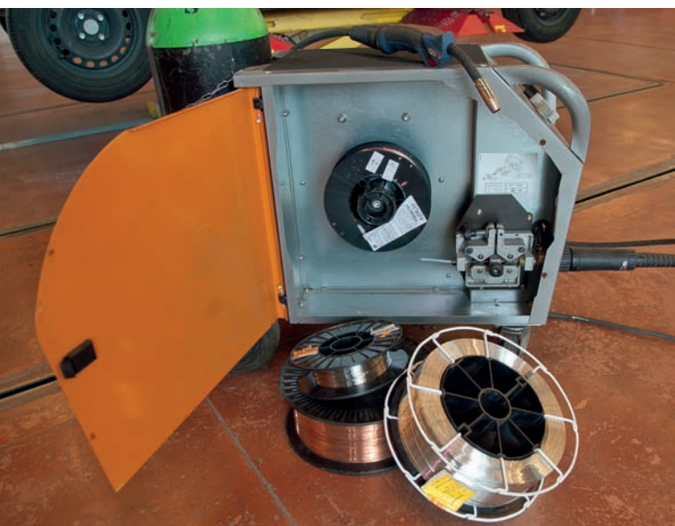
El material del hilo depende de material a soldar y el diámetro del hilo del espesor de las piezas.
