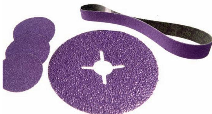
**E**l concepto Cubitron II se basa en unas lijas en los que los granos abrasivos están fabricados a partir de óxido de aluminio cerámico, con un tamaño uniforme y una geometría triangular perfecta, con unas puntas muy afiladas y aristas vivas, posicionadas hacia la superficie de trabajo con gran precisión, de forma que al trabajar los granos abrasivos se van fracturando mientras se desgastan provocando así una especie de autoafilado continuo, maximizando el potencial de corte.
