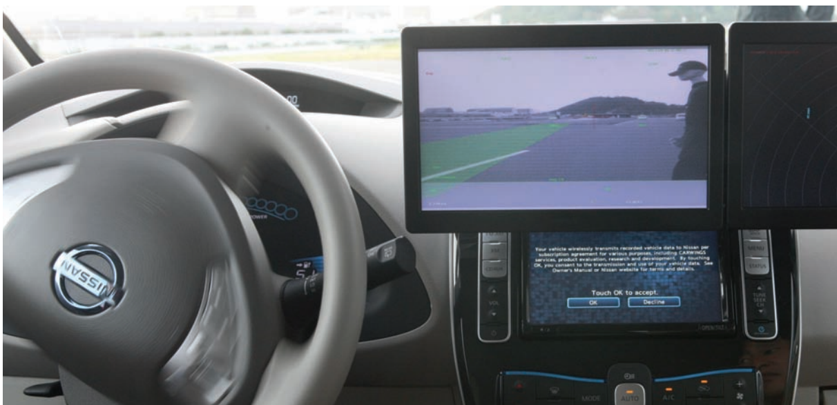
Sistema de Detección de Peatones. Incorporado mediante actualizaciones de software sobre sistemas de frenado automático –AEB– basados en análisis de imagen con cámaras estéreo.
