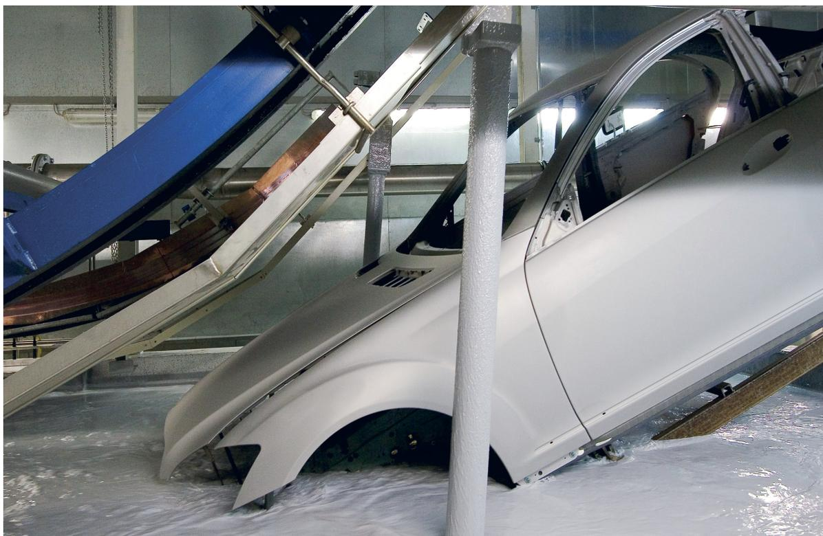
*Cuba de inmersión para aplicación del recubrimiento electroforético.*
