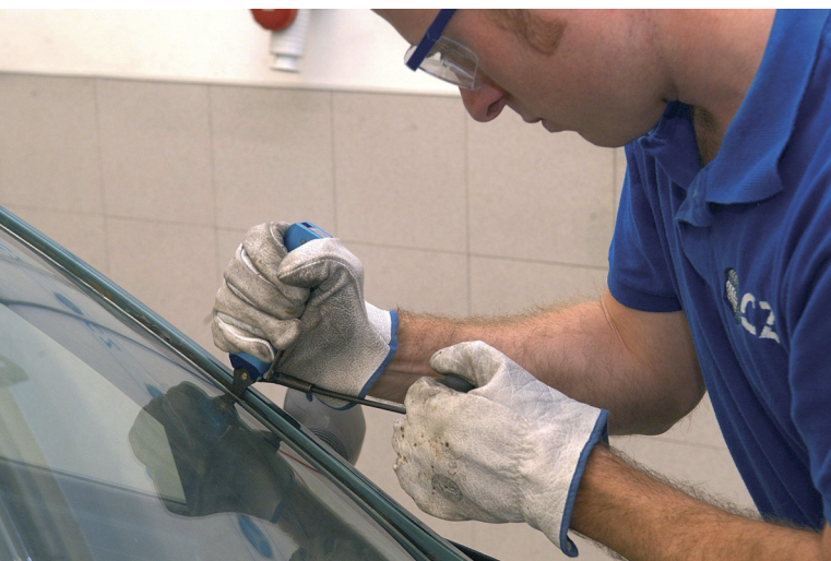
Corte del adhesivo.
