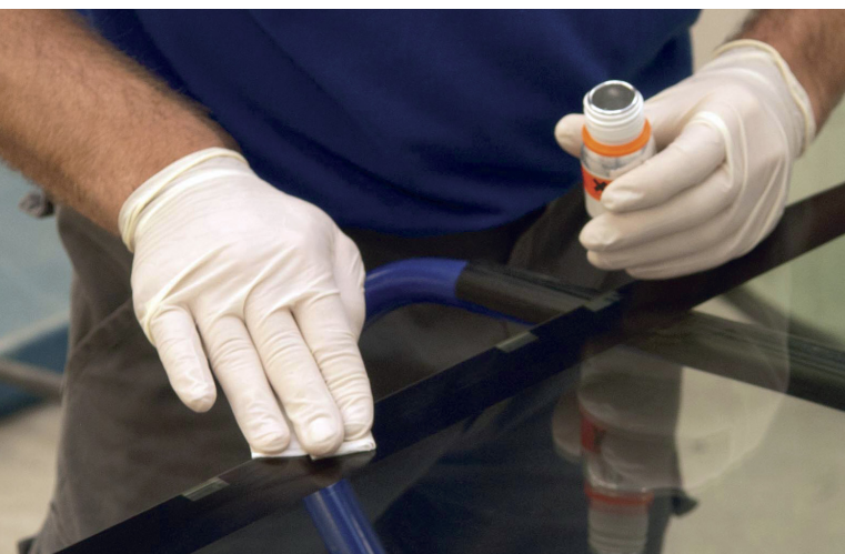
Preparación de las superficies de pegado.
