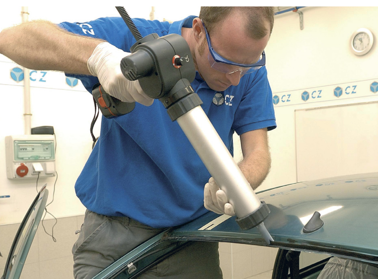
Aplicación del adhesivo.
