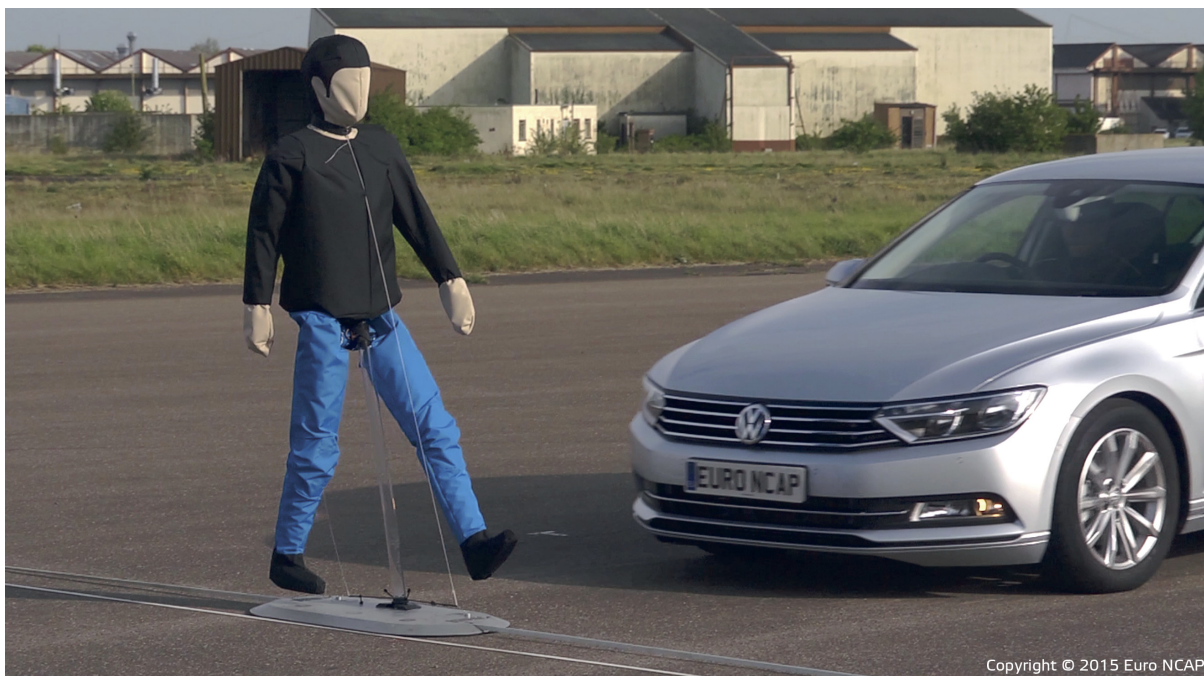
Ensayo llevado a cabo por EuroNCAP simulando un escenario urbano con un adulto caminando (5km/h).
