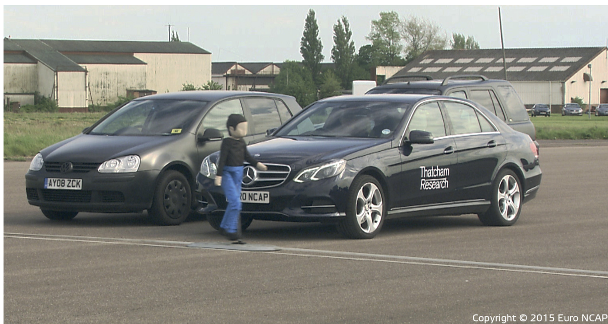
Ensayo llevado a cabo por EuroNCAP simulando un escenario urbano con un niño saliendo corriendo (5km/h) detrás de un coche aparcado.
