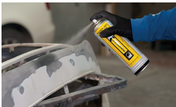
Aplicación de imprimación de anclaje.
