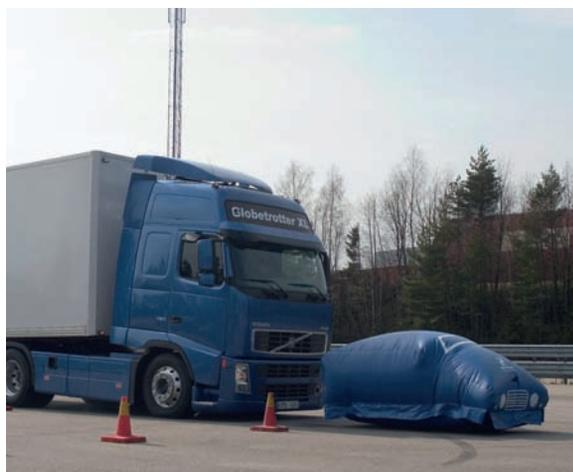
Este tipo de sistemas monitorizan los vehículos que circulan por delante mediante la acción combinada de un radar de medio/largo alcance, normalmente situado en el paragolpes o rejilla delantera, con una cámara situada detrás del parabrisas.
