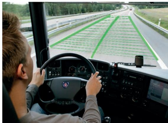
Los sistemas de advertencia de salida de carril, de forma general, entran en funcionamiento a partir de una velocidad de 60-70 km/h.
