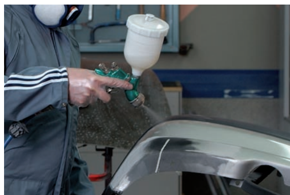
Aplicación de imprimación de anclaje.
