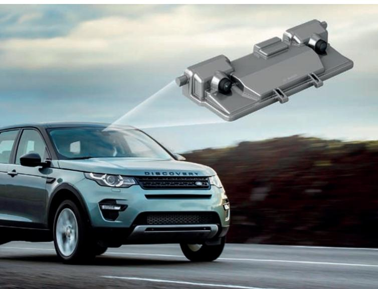
*A través de las cámaras de vídeo y sensores situados en el parabrisas, los sistemas de asistencia al conductor calculan los datos de velocidades y distancias entre vehículos.*
