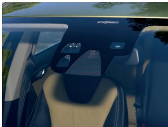
*Los sensores y cámaras de vídeo se sitúan sobre soportes ya premontados en el parabrisas de fábrica.*
