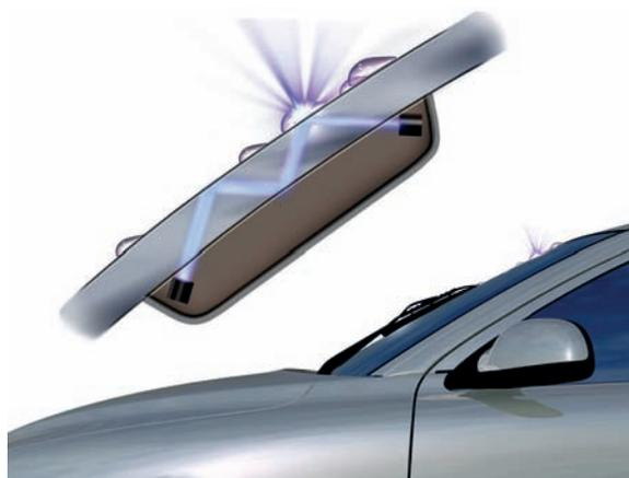
*El sensor de lluvia detecta una cantidad de agua sobre el parabrisas y conecta automáticamente el limpiaparabrisas.*
