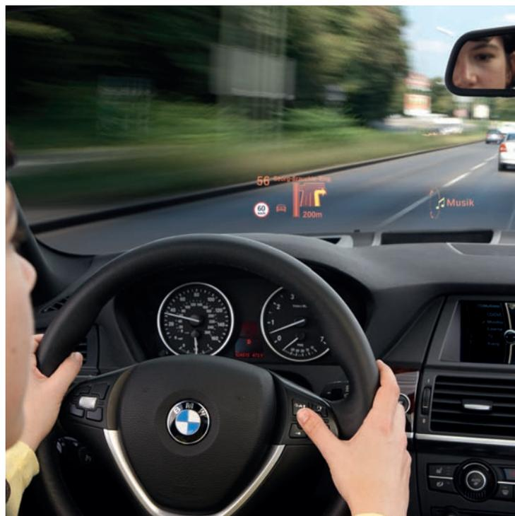
*Los sistemas Head-Up Display permiten al conductor visualizar frontalmente y de forma rápida los datos sobre la conducción.*
