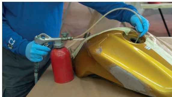
Aplicación interior de imprimación anticorrosiva.
