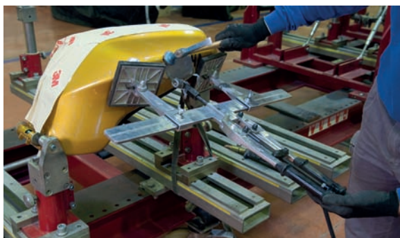
Estiraje del daño mediante el puente.
