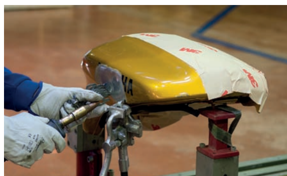
Soldadura de arandelas en la zona deformada.
