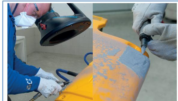
**4** Mecanizar la superficie dañada en forma de V.
