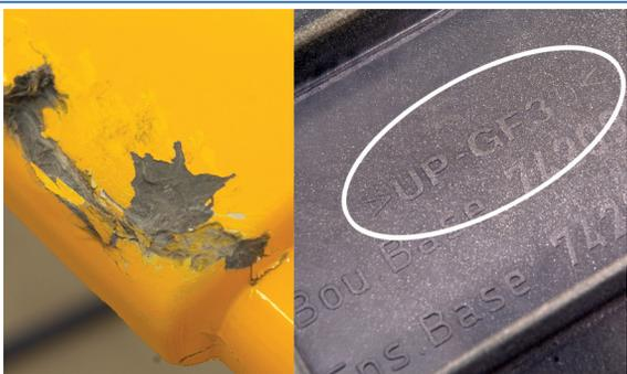
**1** Identificar el daño y el tipo de plástico (los hilos de fibra se verán en la rotura).
