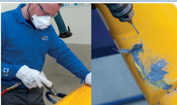
**3** Delimitar mediante un taladrado los extremos de las fisuras y grietas.
