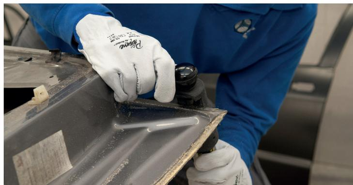
Las piezas amovibles de las carrocerías de automóviles están formadas por un panel exterior y un bastidor. La unión entre estos componentes se realiza generalmente por una unión mixta de adhesivo y engatillado.
