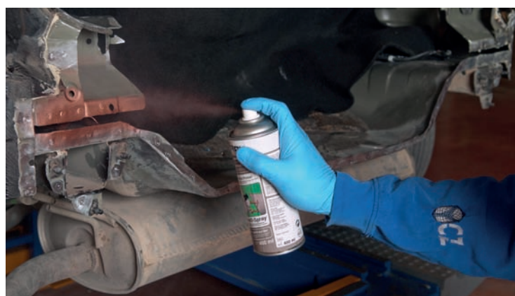
Aplicación de la imprimación L233 en la carrocería.
