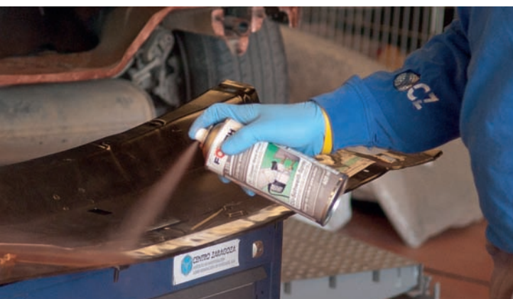
Aplicación de la imprimación en el recambio.
