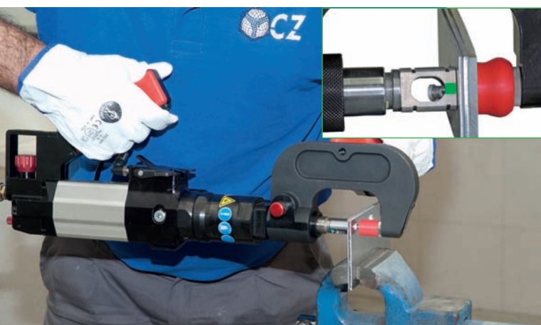
Extracción de remaches autopercutores.
