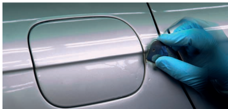
Cuchilla de corte en la eliminación de descolgados.
