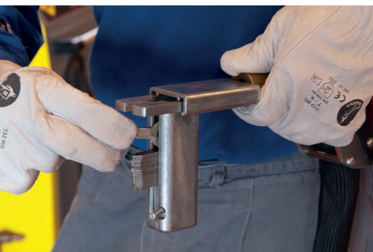
Rellenado del cargador de la pistola porta arandelas.
