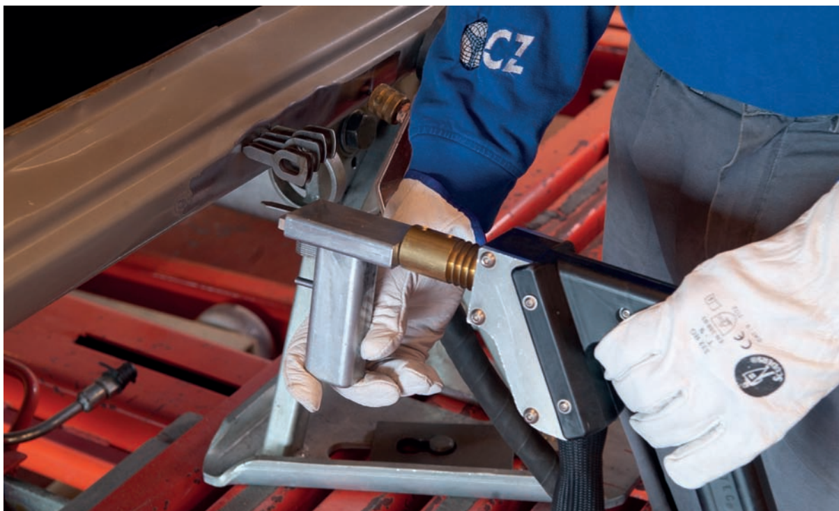
Pistola porta arandelas acoplada en el extremo de la pistola monopunto de la soldadura por resistencia.
