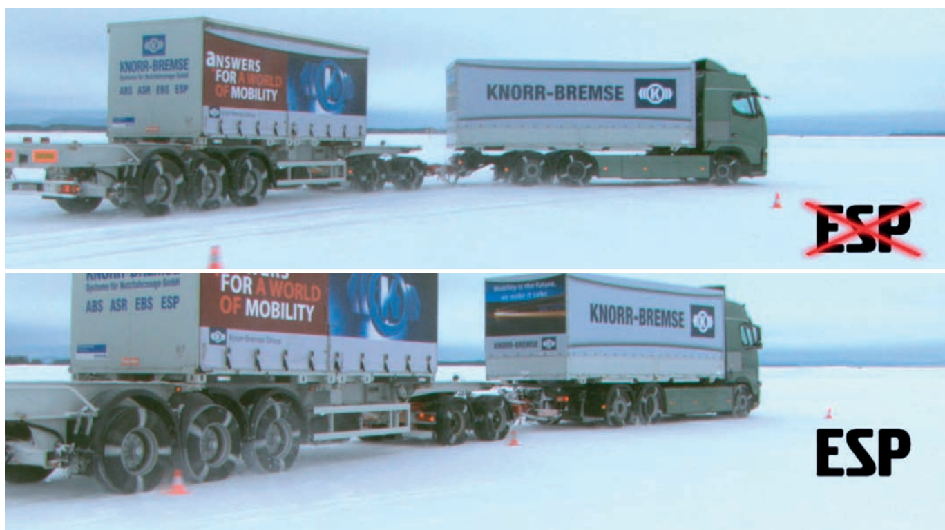
Algunos fabricantes denominan al sistema de control de estabilidad ESP (Electronic Stability Program).
