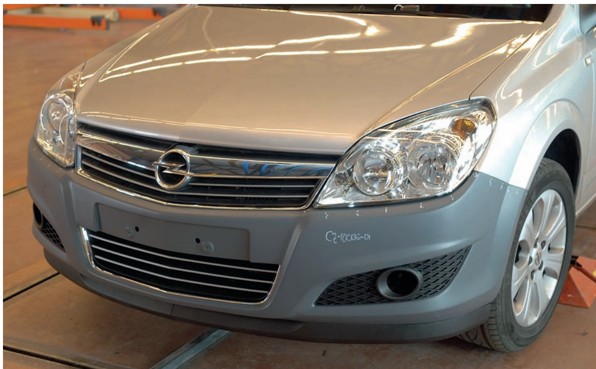
En la prueba de adaptabilidad se verifican las holguras y los enrasos con las piezas adyacentes.
