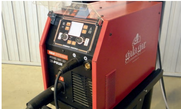
Equipo inverter de soldadura MIG, con tecnología de doble arco pulsado.
