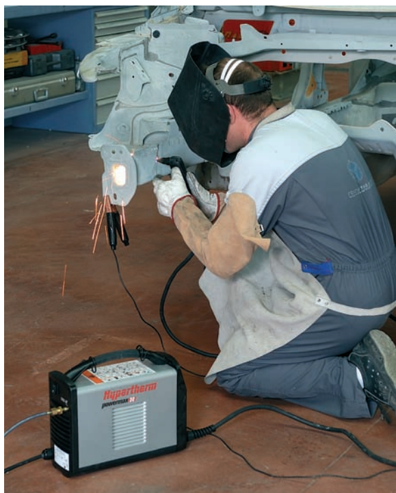
Equipo de corte por plasma para automoción.
