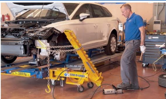
**9** Montar el equipo de estiraje y realizar el estiraje en las zonas deformadas.
