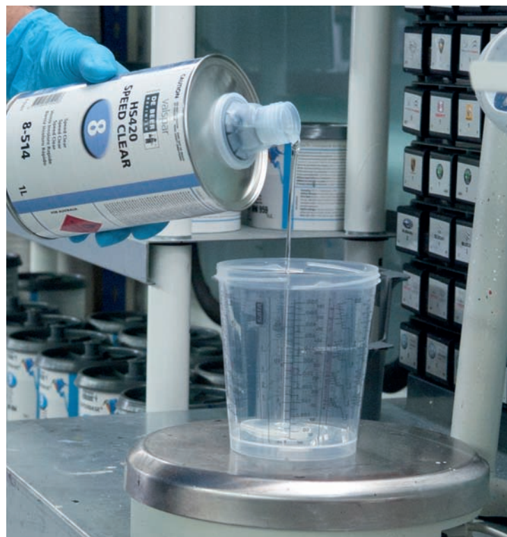
Preparación del barniz 8-514.
