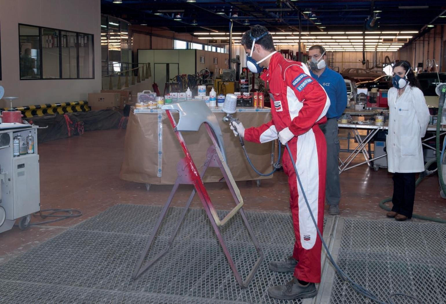
En el caso de aplicarse sobre sustratos plásticos, puede aplicarse igualmente en ciclos húmedo sobre húmedo o en seco, no siendo precisa la aplicación previa de promotor de adherencia en plásticos como ABS, SMC o PUR. En otros sustratos debe aplicarse previamente MAC0, 04363 Universalplast o EL010.
