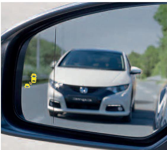
En el caso de que un vehículo sea detectado, un testigo visual es mostrado en el espejo retrovisor del lado correspondiente a aquél en el que se ha detectado el vehículo aproximándose y en el caso de que el conductor active el intermitente de dicho lado, el aviso visual emite un parpadeo, a la vez que suena una alarma acústica.
