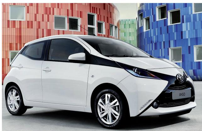
De serie en todos los modelos del nuevo Aygo, los faros delanteros incorporan unas lámparas halógenas con sistema polielipsoide PES (Poly-Ellipsoid System), que proporcionan una iluminación más amplia y de mayor alcance tanto en luces cortas como en largas, y luces de posición LED integradas, que confieren al nuevo Aygo una firma luminosa única, identificable desde lejos.
