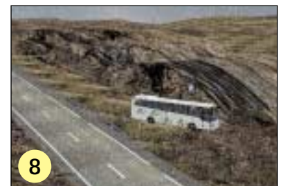
8 LA SALIDA DE VÍA SE PRODUJO JUSTO POR DELANTE DE LA VALLA METÁLICA DE PROTECCIÓN, POR LO QUE ÉSTA NO CUMPLIÓ CON SU MISIÓN.
