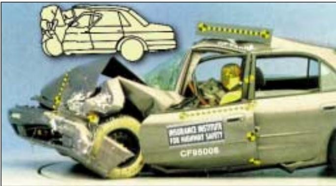
COCHE MAL DISEÑADO PARA EL CHOQUE DESCENTRADO
