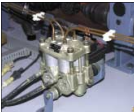
GRUPO HIDRÁULICO DE CUATRO CANALES
