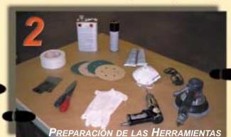
Adhesivos bicomponentes de diferentes flexibilidades, espátulas, imprimador, limpiador-preparador, lijadora roto-orbital con aspiración, juego de lijas y los equipos de protección necesarios.
