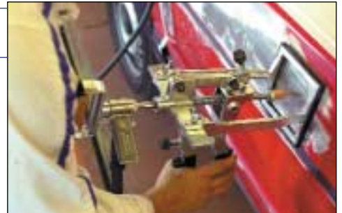
REPARACIÓN CON MIRACLE EASY PULLER
