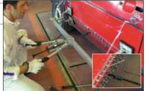
REPARACIÓN CON MIRACLE LINE PULLER
