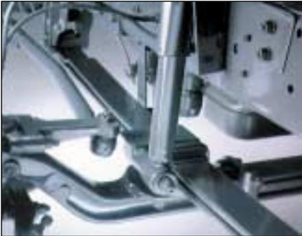
La sección transversal de la viga del bastidor es la sección resistente que se opone a que la viga se
