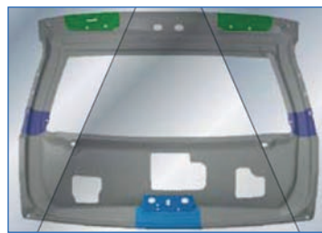
Inclusión de refuerzos en el portón usando la técnica Tailored Welded Blank.
