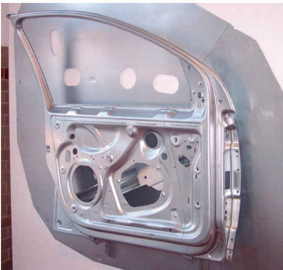
Bastidor de puerta fabricado con la técnica Tailored Welded Blank.
