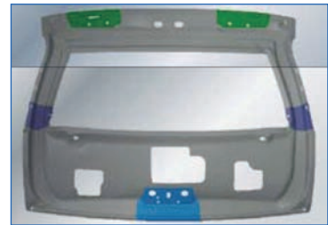
Inclusión de refuerzos en el portón usando la técnica Tailored Welded Blank.
