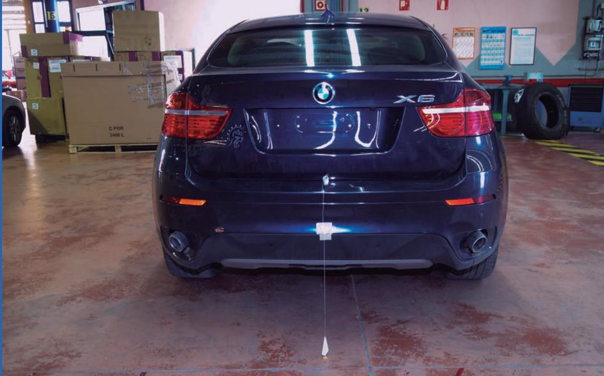
Para medir la anchura, comenzaremos por identificar los puntos más salientes de cada lado del vehículo que generalmente se encuentran a la misma altura en ambos laterales. Sobre los puntos identificados colgaremos la plomada para trazar en el suelo la proyección vertical de dichos puntos.
