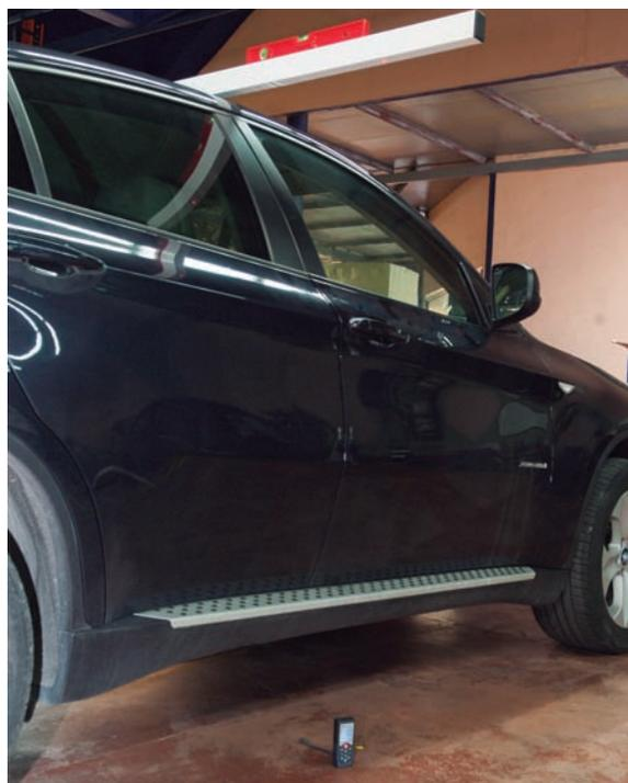
determinación de la anchura máxima no se considerará la parte fija de los retrovisores unida a la cabina siempre y cuando no sobresalga de la anchura máxima del vehículo más de 50 mm por cada lado.
