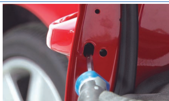
4 Desenroscar hasta el tope el tornillo prisionero.
