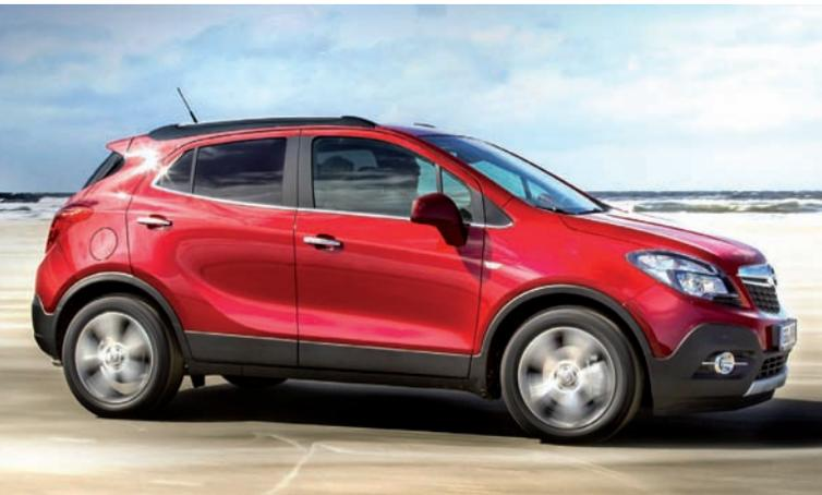
**Clima variable:** el sistema 4x4 del Mokka es capaz de enviar tracción a las ruedas traseras de forma puntual, por ejemplo, al superar una placa de hielo. Cuando es necesario, el par motor se envía también a las ruedas traseras para aumentar la adherencia y el control.
