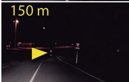
El alcance visual de un conductor circulando con alumbrado de cruce de un peatón haciendo uso de prendas retrorreflektantes es de más 150 metros. Por lo tanto, aun circulando un vehículo a 100 km/h, éste puede ser detenido dentro del alcance visual de su conductor.
