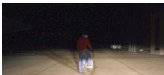
El alcance visual de un conductor circulando con alumbrado xenon de cruce aumenta ligeramente respecto al alumbrado halógeno, ya que en este caso, un conductor circulando con este tipo de alumbrado puede comenzar a reconocer a un ciclista con ropas oscuras a unos 40 metros aproximadamente.
