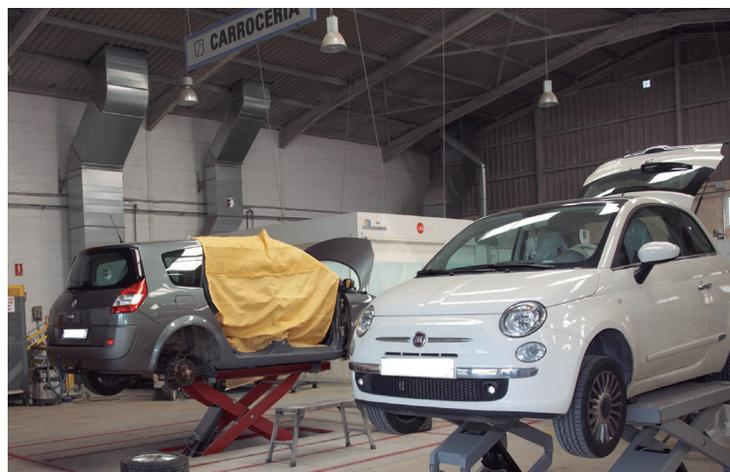
ración, 3 equipos de secado por infrarrojos, 1 bancada con vigas empotradas en el suelo con su correspondiente equipo de medidas, 1 equipo de soldadura eléctrica por puntos, 1 equipo de soldadura eléctrica MIG-MAG y 1 equipo de calentamiento por inducción magnética.
