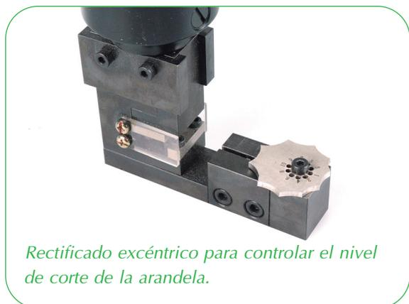
*Rectificado excéntrico para controlar el nivel de corte de la arandela.*
