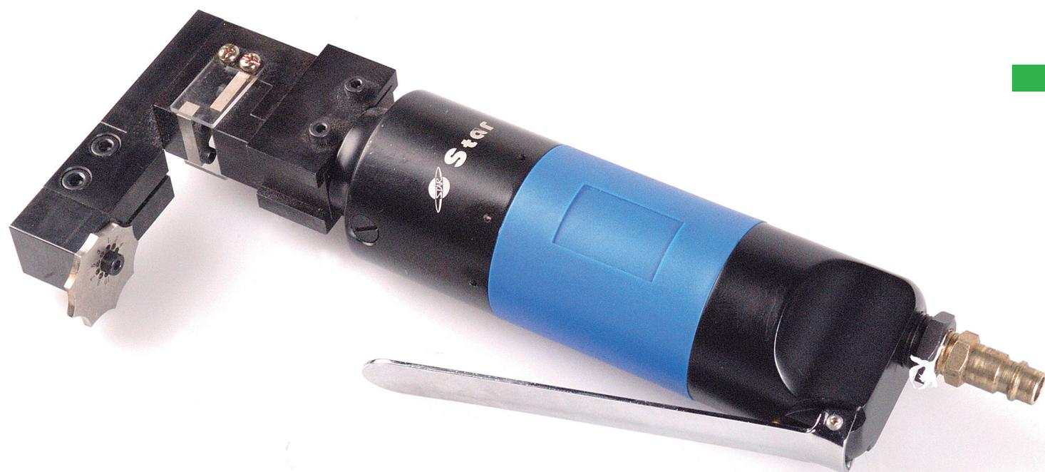
El Bit Cutter es una herramienta neumática, que incorpora un regulador excéntrico, con 10 posiciones, que permite controlar la profundidad de corte a realizar en la arandela. De esta forma que es posible repasar las arandelas y dejarlas todas a la misma longitud.
