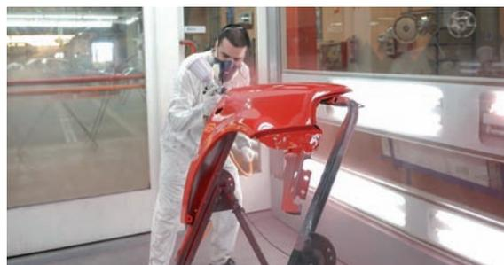
gruencia que por ejemplo resultaría de sustituir un estribo bajo puerta, y pretender pintarlo desmontado, para luego soldarlo a la carrocería.
